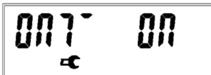
Рисунок 29 – Оптопорт включен
