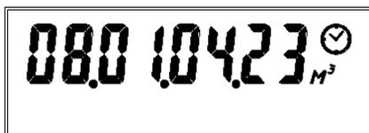
Рисунок 6 – Отображение даты и времени показания в архиве
