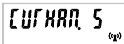
Рисунок 36 – Отображение уровня сигнала при передаче информации по GSM каналу
