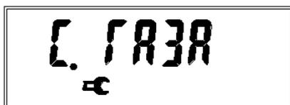
Рисунок 32 – Отображение пункта меню «Подстановочный параметр – коэффициент сжимаемости газа»
