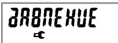
Рисунок 30 – Отображение пункта меню «Подстановочный параметр – давление газа»
