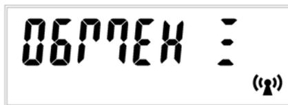
Рисунок 37 – Индикация обмена информацией по GSM каналу
