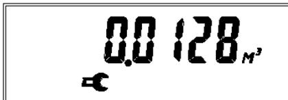
Рисунок 26 – Значение накопленного объема газа без коррекции
