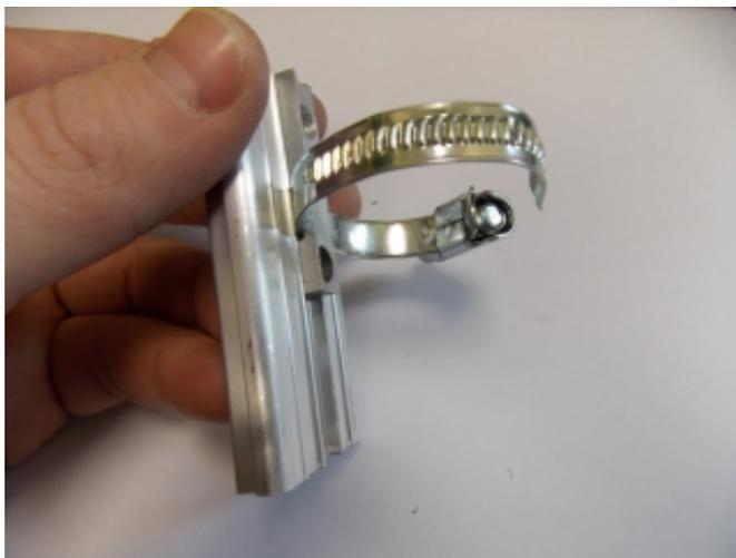
1.2 Закрепить монтажную конструкцию на калаче конвектора, затянув червячный хомут:
