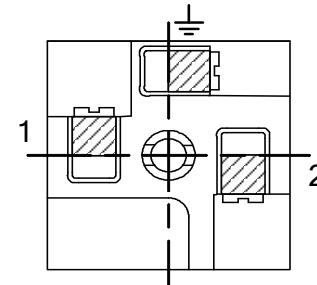
Расположение контактов на розетке разъема со стороны винтового закрепления проводников (Разъем в соответствии DIN43650C серии GDM с 3 контактами).
