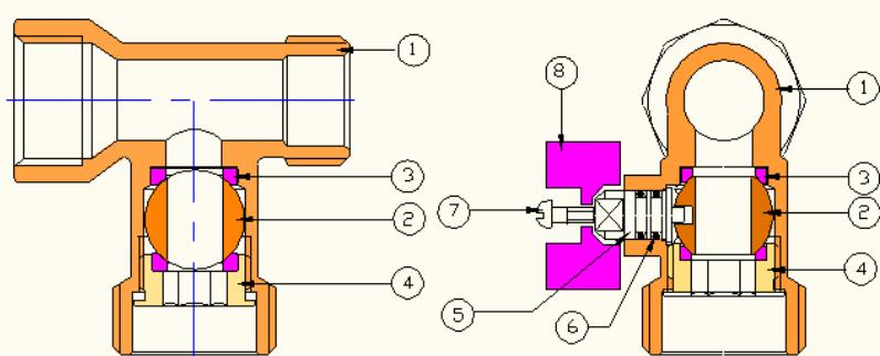
прессования с гальванопокрытием из никеля. В боковом отводе тройника расположен шаровой затвор из хромированной латуни 2, который приводится в движение латунным штоком 5 с помощью ручки 8 из PA-6 пластика. Шток имеет сальниковое уплотнение из двух колец 6 из EPDM. Уплотнение шарового затвора выполнено из тefлоновых колец 3 с помощью латунной прижимной гайки 4. Гайка имеет шестигранный проход (под ключ).
