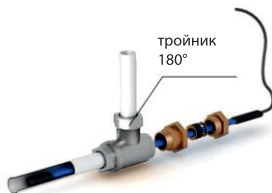
Рис. 2 - Схема прямого ввода нагревательной секции внутрь трубопровода
