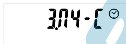
Рисунок 25 – Код события «Предупреждение»
