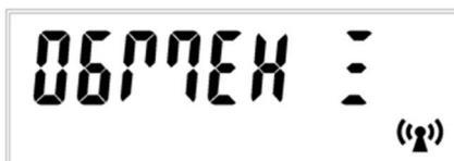
Рисунок 48 – Индикация обмена информацией по GSM каналу
