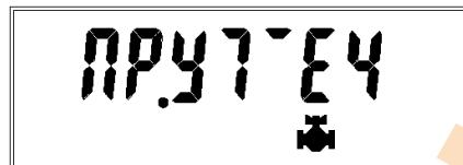
Рисунок 51 – Режим обнаружения утечки
