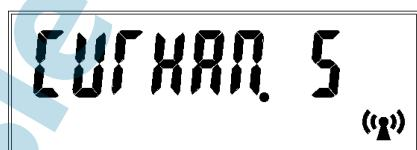
Рисунок 47 – Отображение уровня сигнала при передаче информации по GSM каналу
