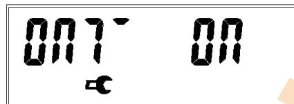
Рисунок 36 – Оптопорт включен
