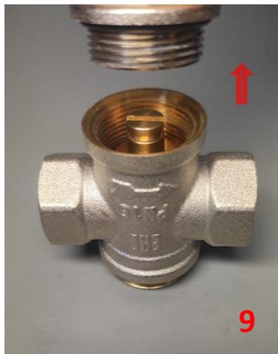
10. Рожковым ключом на 8 мм фиксируем поршень.
