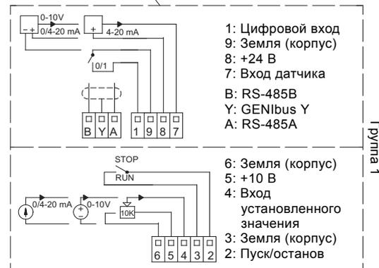
Рис. 107 Соединительные клеммы насосов TPED серии 2000
