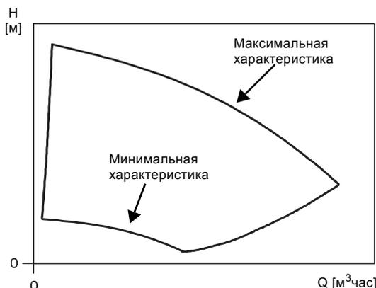
Рис. 83 Максимальная и минимальная характеристики производительности
