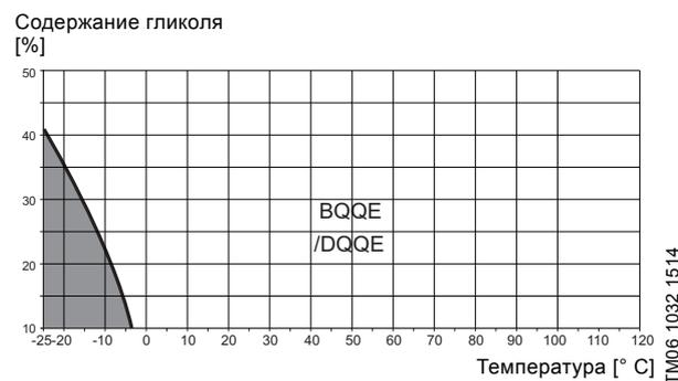
Рис. 7 Рабочий диапазон уплотнений вала из EPDM
