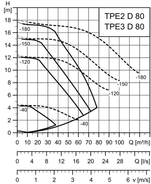
Примечание: Пунктирные линии кривых Q, H относятся к насосам TPE2 D, TPE3 D, работающим параллельно.
