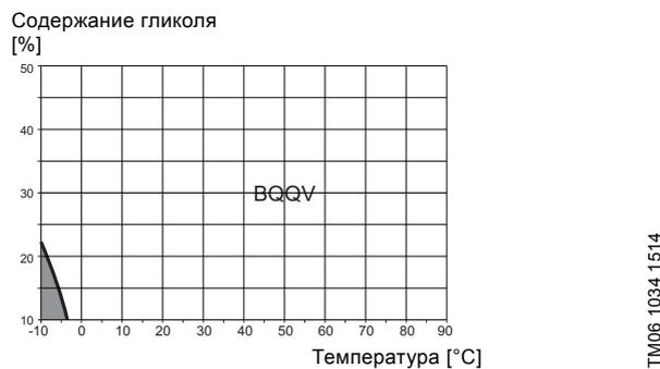
Рис. 8 Рабочий диапазон уплотнений вала из FKM
