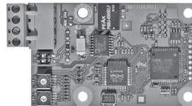
Рис. 121 Модуль передачи данных CIM
