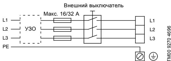
Рис. 105 Схема электрических соединений
