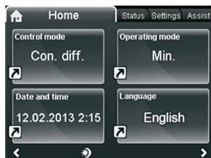
Рис. 17 Пример главного дисплея на насосе TPE серии 2000
