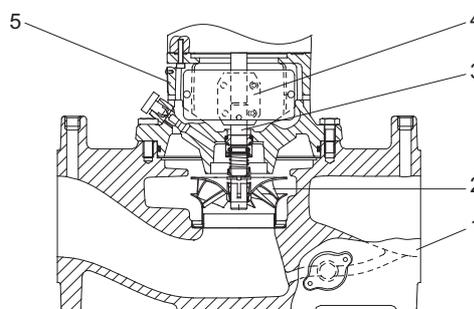
Рис. 11 Чертеж в разрезе насоса TP серии 200 (с фланцевым соединением)
