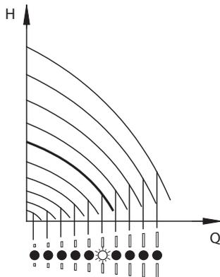
Рис. 32 Насос в режиме управления с постоянной характеристикой
