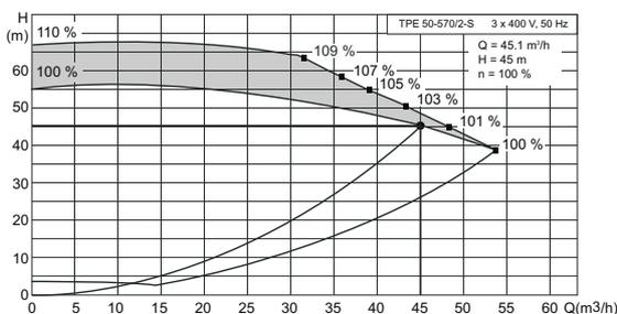
Рис. 22 Насосы TPE(D) с расширенным диапазоном производительности
