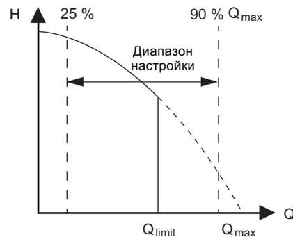
Рис. 68 FLOW<sub>LIMIT</sub>
