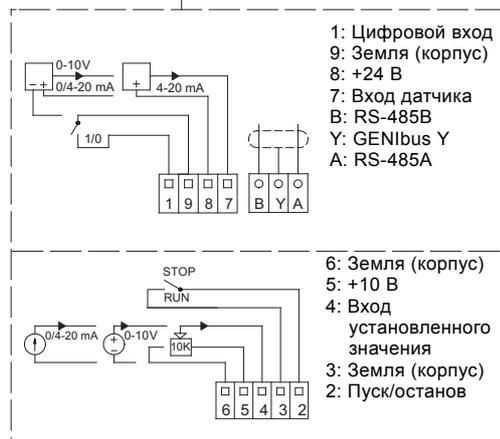
Рис. 106 Клеммы соединений
