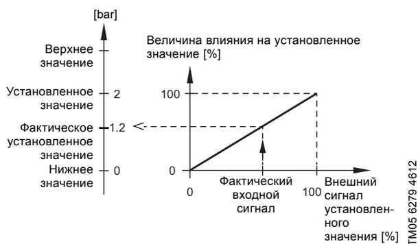
**Рис. 70** Пример влияния на внешнее установленное значение
