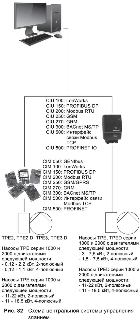
**Рис. 82** Схема центральной системы управления зданием
