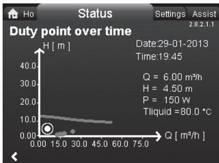
Рис. 24 Пример дисплея состояния для насосов TPE3
