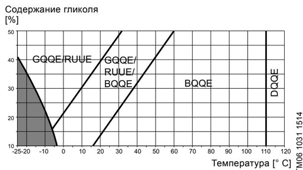
Рис. 5 Рабочий диапазон уплотнений вала из EPDM
