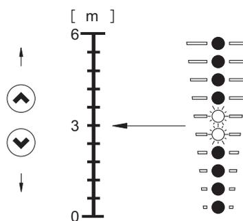
Рис. 31 Установленное значение - 3 м, управление перепадом давления
