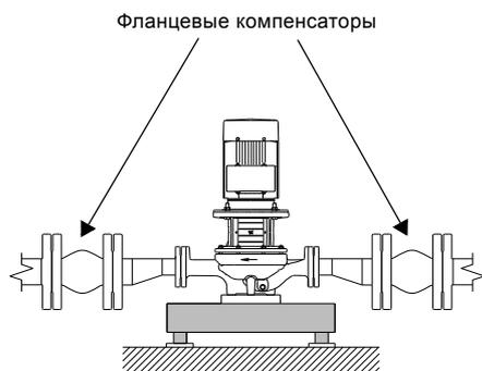
Рис. 95 Насос TP с вибровставками большего размера
