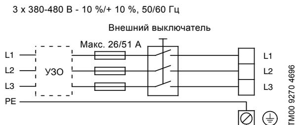
Рис. 108 Схема соединений, трехфазные электродвигатели MGE, 11-22 кВт
