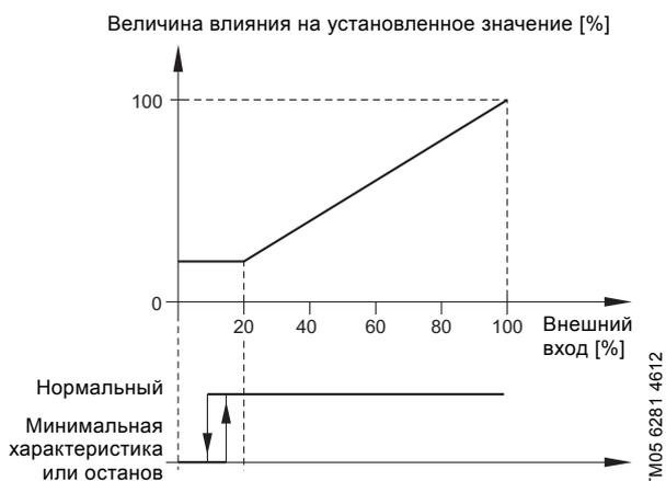
Рис. 72 "Линейная функция с остановом" и "Линейная функция с минимальной характеристикой"
