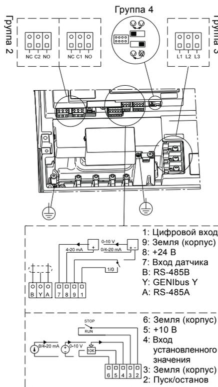
Рис. 110 Соединительные клеммы насосов TPED серии 2000
