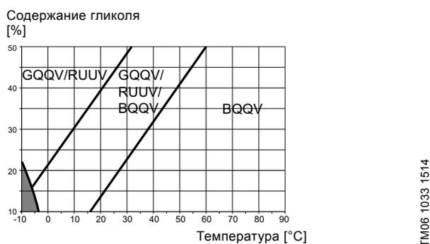
Рис. 6 Рабочий диапазон уплотнений вала из FKM
