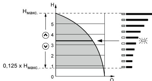
Рис. 43 Насос в режиме управления "Постоянное давление"
