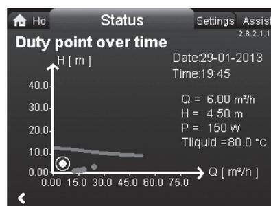
Рис. 1 Пример дисплея состояния для насосов TPE3
