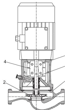
Рис. 10 Чертеж в разрезе TP серия 100 (с муфтовым соединением)
