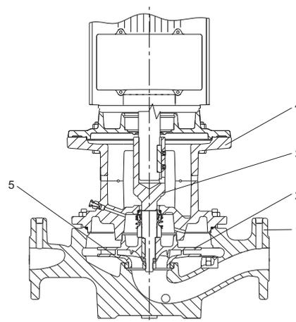
Рис. 13 Чертеж насоса TP серии 300 в разрезе
