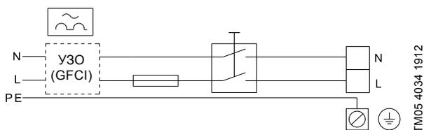
Рис. 100 Пример подключения к сети электродвигателя с выключателем электропитания, плавким предохранителем и дополнительной защитой
