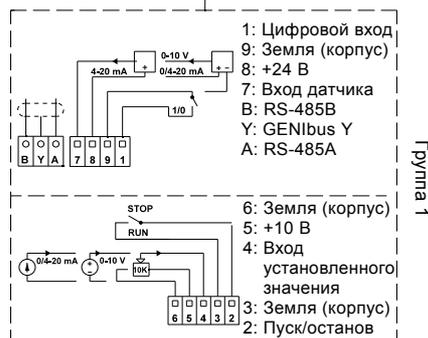
Рис. 109 Клеммы соединений
