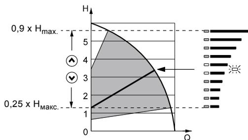
Рис. 42 Насос в режиме управления "Пропорциональное давление"
