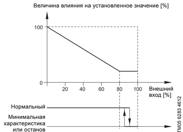
Рис. 74 "Обратная функция с остановом" и "Обратная функция с минимальной характеристикой"
