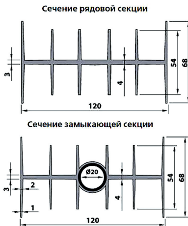
Рис.6 «TENRAD AL/BM» - сечение секций
