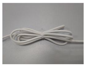
Уложить пучок провода в полость между теплообменником и кожухом конвектора. Зафиксировать кожух конвектора крепежными винтами (в случае его демонтажа) и установить декоративную решетку на место.
