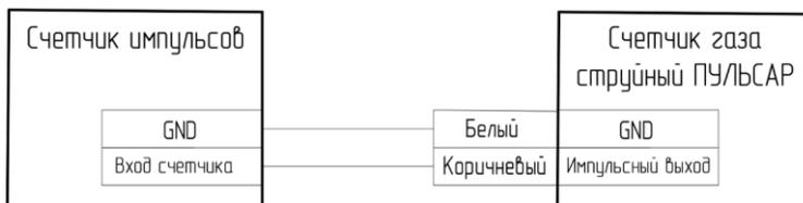
Рисунок 2 – Схема подключения счетчика импульсов
