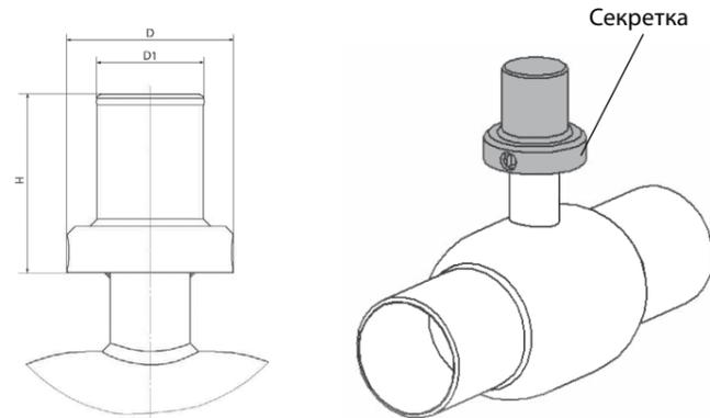
Специальный ISO фланец для установки приводов на краны шаровые БРОЕН БАЛЛОМАКС®
