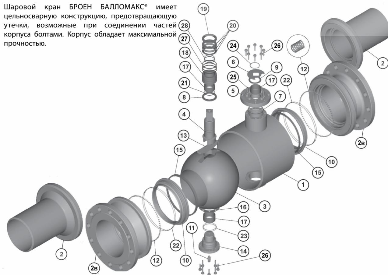
Конструктивные особенности крана шарового БРОЕН БАЛЛОМАКС® (КШГ) в полно-проходном исполнении:
