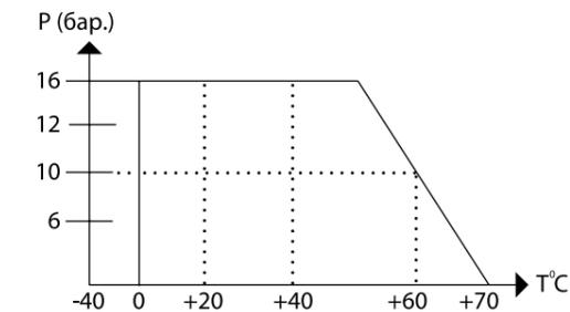
График зависимость «Температура - давление»
