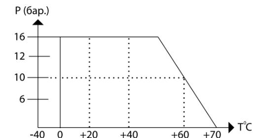
График зависимость «Температура - давление»
