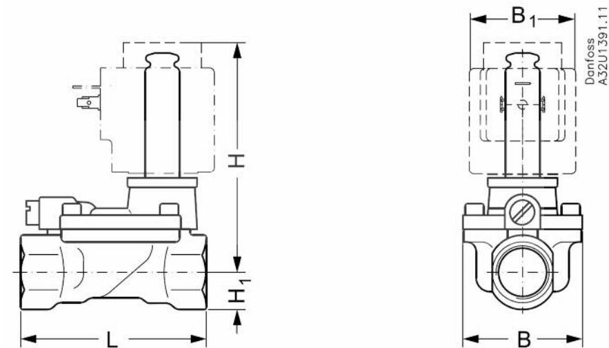
Рис. 3. Габаритные и присоединительные размеры клапана электромагнитного.
