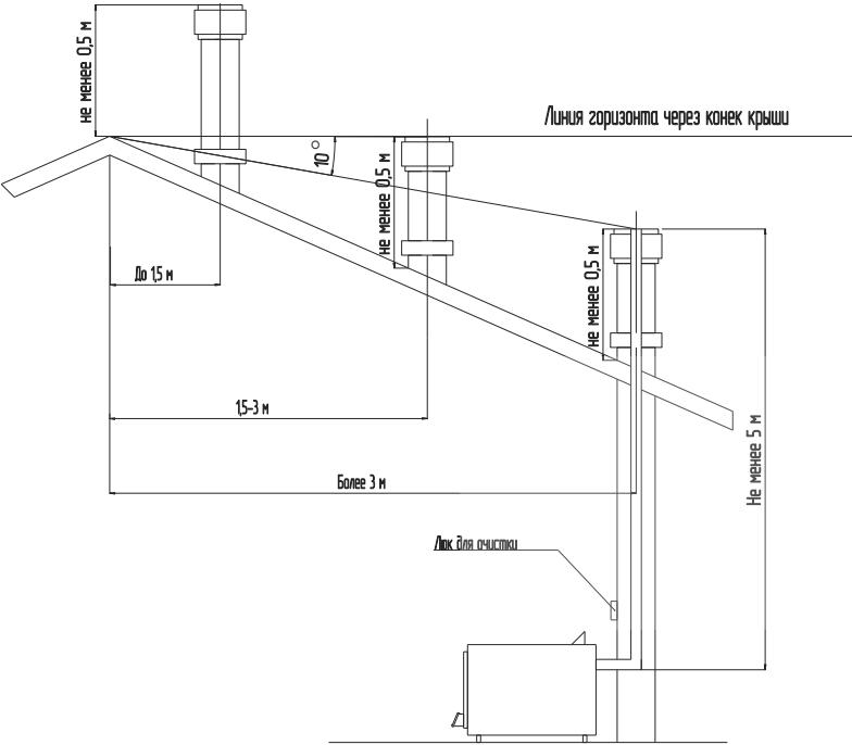
**Рисунок 3 Варианты установки дымовой трубы**
